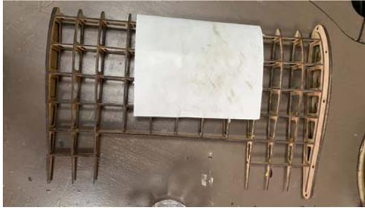
写真 8 木製固定翼機の試作品
